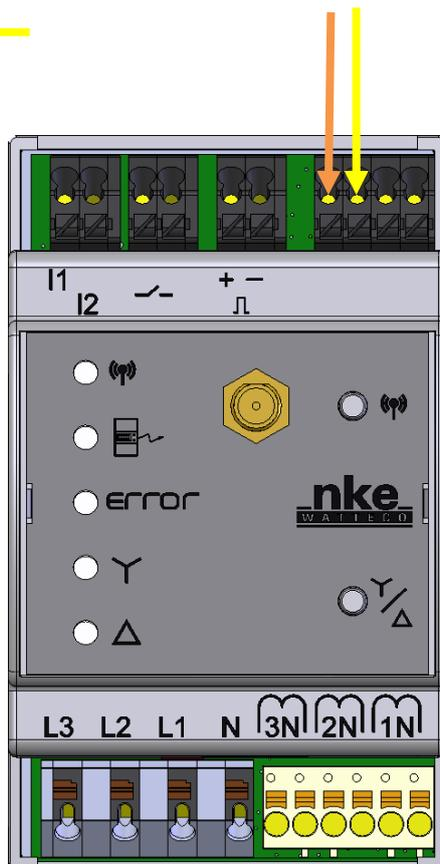
La sortie RS485 est activée les 5 premières minutes. Il est possible de la réactiver en appuyant sur le bouton de configuration du Triphas'O :
